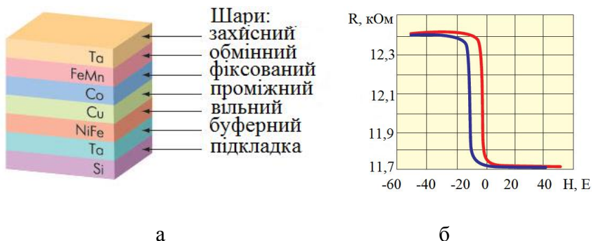
Рисунок 3.4 – Приклад структури спін-вентилля (а) та його робочої характеристики (б)
