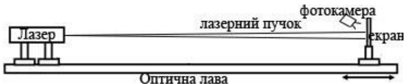
Рисунок 3 – Схема експериментального вимірювання енергетичного розходження пучка лазерного випромінювання
