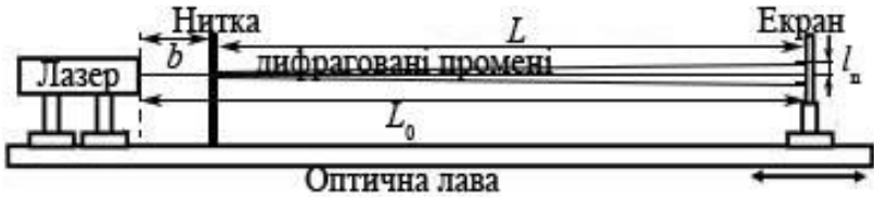
Рисунок 3 – Схема експериментального одержання дифракційної картини від тонкої нитки
