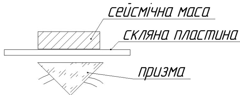
Рис.7.19. Схема датчика прискорення з використанням тунельного ефекта
