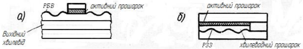
Рис. 8.7. Резонатори на базі дифракційних ґраток: а – з РБВ; б – з Р33
