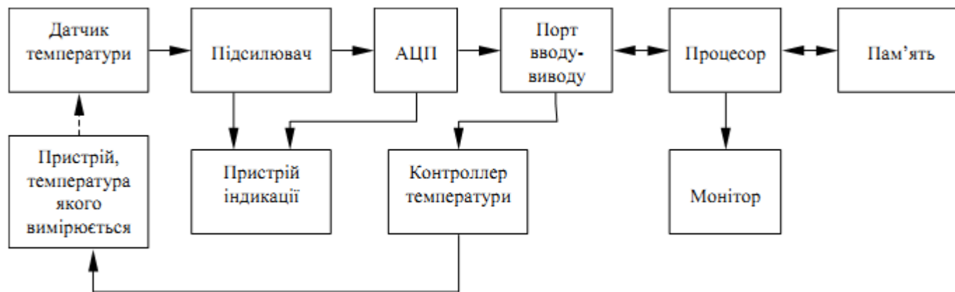
Рис. 1.1. Структурна схема електронного термометра
