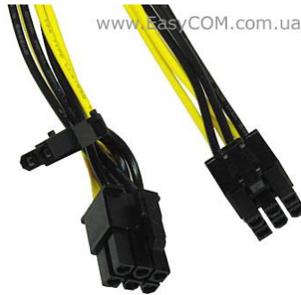
Рисунок 2.26 – 6-контактне та 6+2-контактне рознімання живлення відеокарт PCI-E
