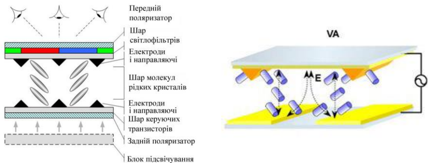
Рисунок 2.54 – До пояснення принципу роботи та будови MVA матриці
