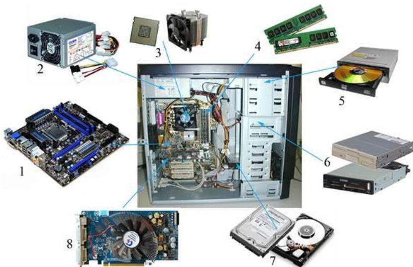
Рисунок 2.3 – Системний блок: 1 – материнська плата; 2 – блок живлення; 3 – процесор, що охолоджується вентилятором (кулером); 4 – оперативна пам'ять; 5 – дисковий привід; 6 – карт-рідер або привід для зчитування гнучких дисків (Floppy); 7 – жорсткий диск; 8 – відео карта
