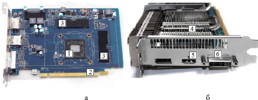
Рисунок 2.38 - Зовнішній вигляд (вид зверху (а) та збоку (б)) дискретної відеокарти Sapphire Radeon HD 7750 ULTIMATE: 1 – графічний процесор; 2 – інтерфейс PCI Express; 3 – радіатори, встановлені на чипах відеопам’яті; 4 – радіатор для охолодження GPU; 5 – роз’єми HDMI; 6 – роз’єми DVI
