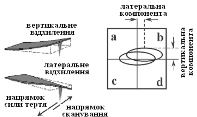
Рис. 7.17 Схема зміщення лазерної плями при відхиленні кантилевера
