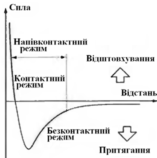
Рис. 7.15 Якісна залежність сили Ван-дер-Ваальса від відстані
