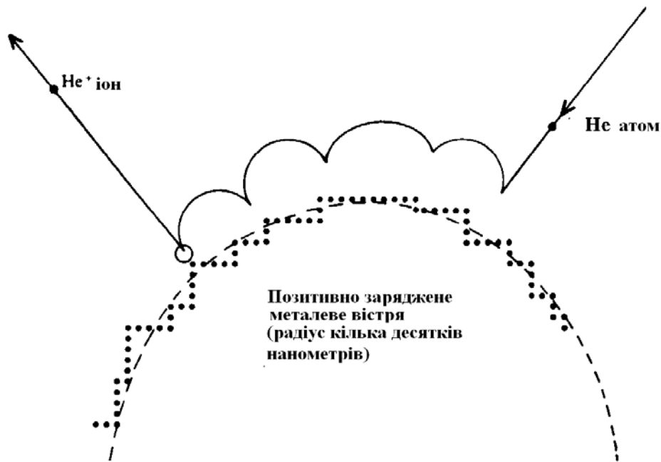
Рис. 8.5 Схема руху атома гелію в польовому іонному мікроскопі
