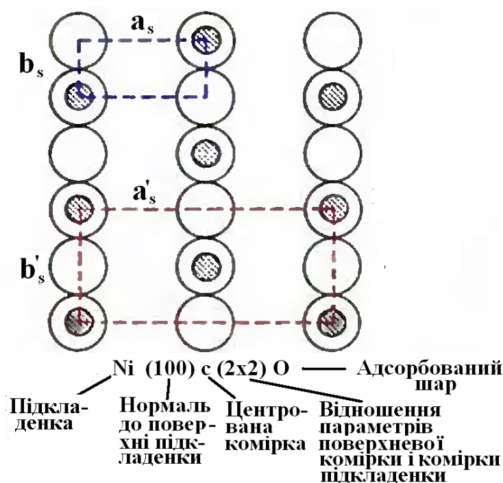
Рис. 6.18 Структура поверхневої центрованої прямокутної решітки Ni(110)c(2x2)-O, утвореної атомами кисню на поверхні Ni (110).
