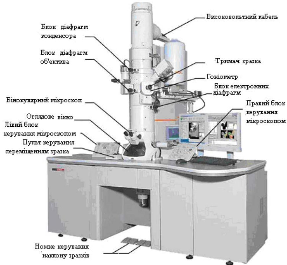
Рис. 12. Конструкція просвічуючого електронного мікроскопу
