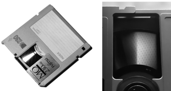
Рис. 7.11. Загальний вигляд магнітооптичного диска розміром 90 мм і видимі оптичні мітки на поверхні магнітооптичного носія
