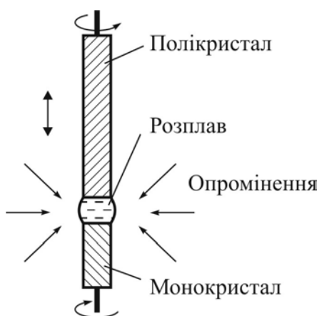
Рис. 10.1. Конфігурація «зародок-кристал» для вирощування кристалів методом безтигельної зонної плавки
