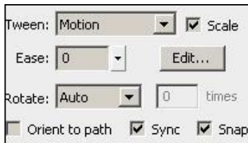
Рисунок 2 – Встановлення прив'язки кінців траєкторії до центру об'єкту
