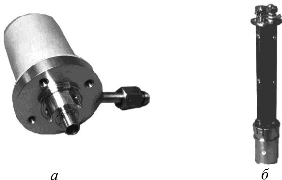
Рис.3. Зовнішній вигляд джерела іонів (а) та мас-аналізатора (б)
