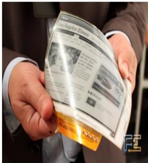
Рис. 2. Зовнішній вигляді електронної книги на основі гнучкого екрану E-ink (а) гнучкий електронний папір від компанії «LG Electronix» (б).
