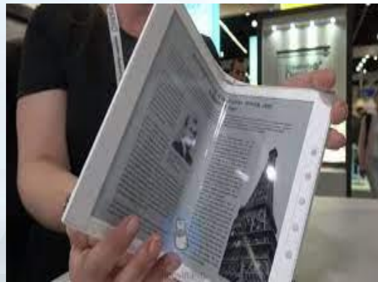
Рис. 2. Зовнішній вигляді електронної книги на основі гнучкого екрану E-ink (а) гнучкий електронний папір від компанії «LG Electronix» (б).
