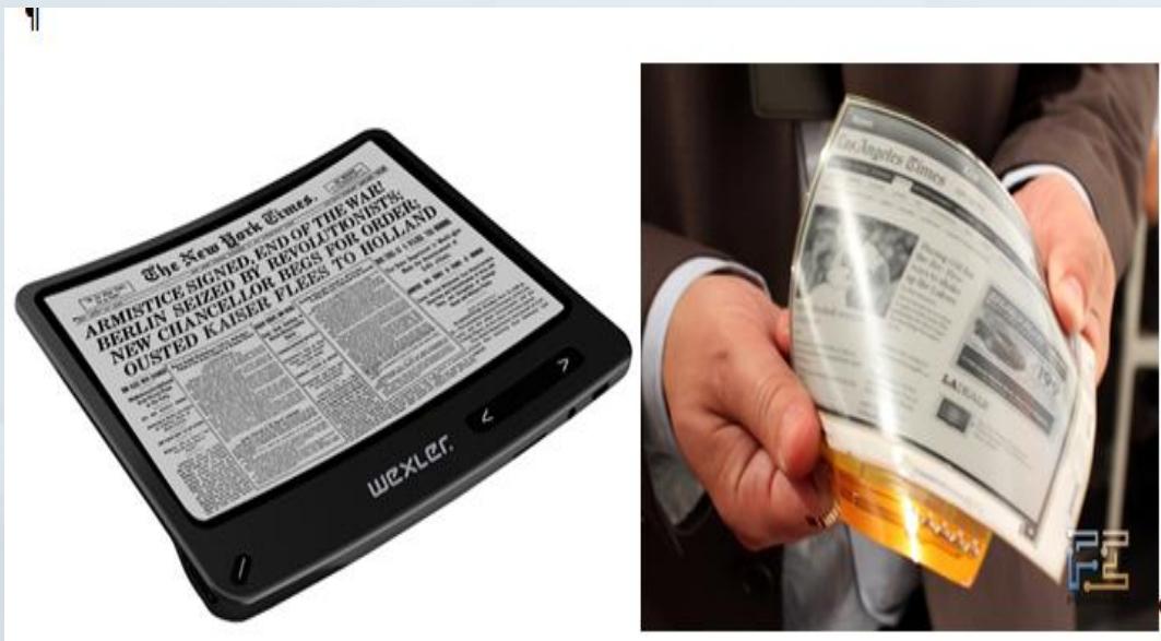
Рис. 2. Зовнішній вигляді електронної книги на основі гнучкого екрану E-ink (а) гнучкий електронний папір від компанії «LG Electronix» (б).
