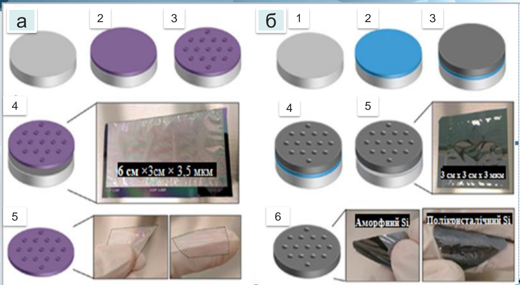
Рис. 1 Схема отримання тонкої мембрани аморфного кремнію (а): 1 – кремнієва підкладка; 2 – шар \text{SiO}_2 ; 3 – шар з порами; 4 – відділена тонка плівка; 5 – готова структура. Схема отримання тонкої мембрани полікристалічного кремнію (б): 1 – кремнієва підкладка; 2 – шар \text{SiO}_2 ; 3 – шар полікристалічного кремнію; 4 – шар з порами; 5 – відділена тонка плівка; 6 – готова структура.
