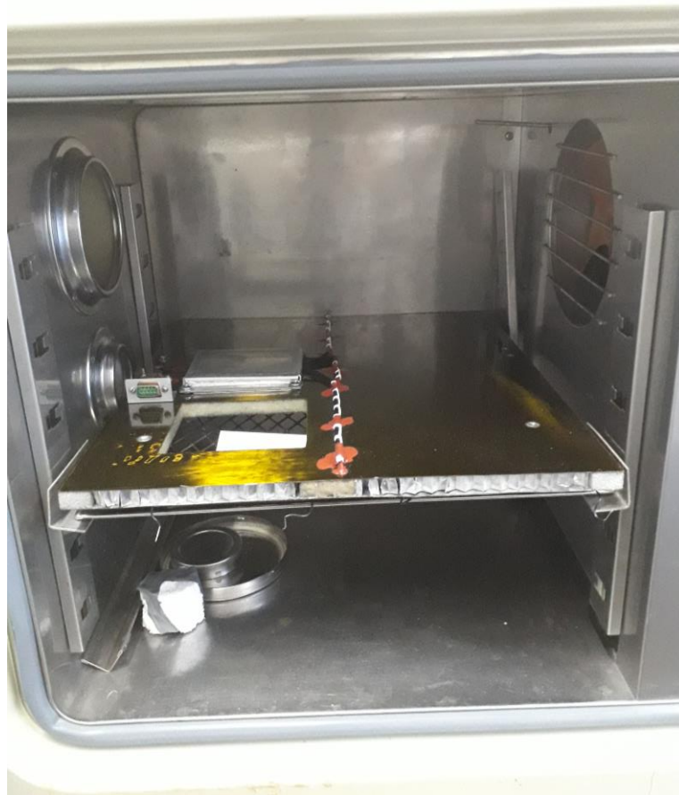
Рисунок 2.6 – Розташування ДЗ ЕПОВН в камері тепла
