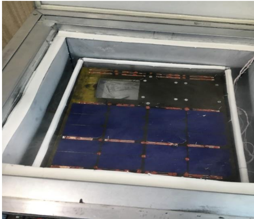
Рисунок 2.5 – Розташування ДЗ ЕПОВН в камері холоду
