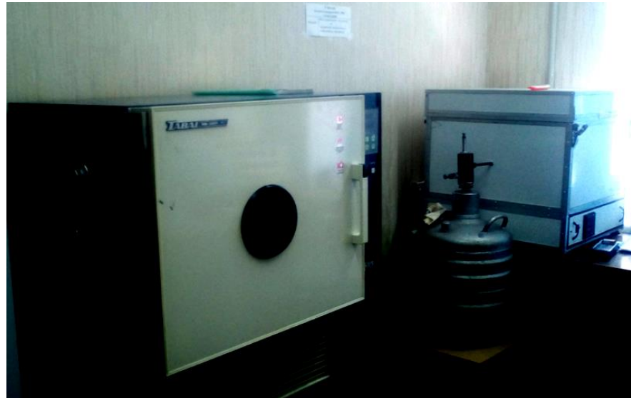
Рисунок 1.4 – Обладнання для проведення термоциклічних випробувань ЕЗ ЕПОВН БС
