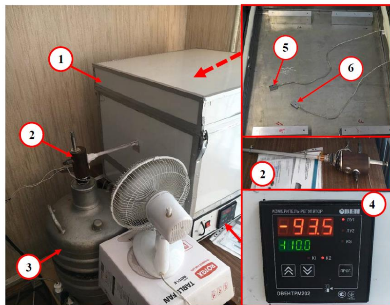
Рисунок 1.5 – Загальний вигляд камери холоду для проведення термоциклічних випробувань ЕЗ ЕПОВН БС
