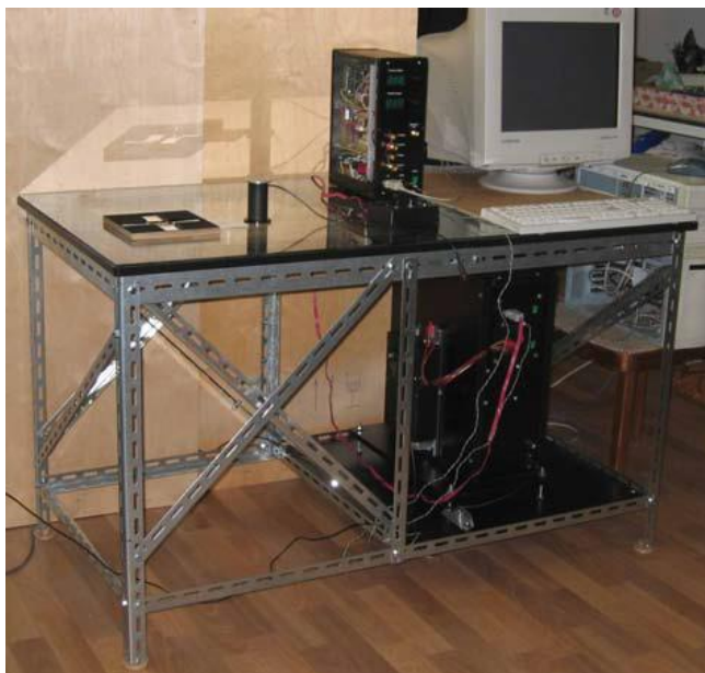
Рис. 2.5. Імпульсний тестер концентраторних ФЕМ
