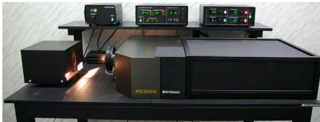
Рис. 2.3. Установа для дослідження спектральних характеристик багатоперехідних СЕ
