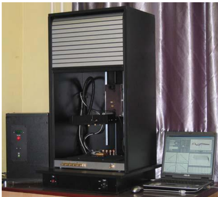
Рис. 2.4. Імпульсний тестер для СЕ
