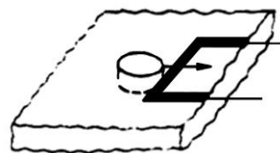
Рисунок 1.39 – Магніто-резистивна петля для зчитування інформації
