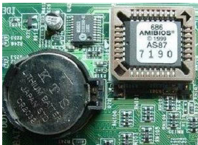
Рисунок 1 – Материнська плата ПК (вигляд зовні) з розміщеними на ній мікросхемою BIOS та акумулятором
