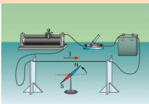
При проходженні електричного струму по провіднику магнітна стрілка, розташована поблизу провідника, відхиляється від напрямку «північ — південь»
