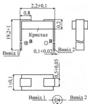
Рис. 2.9. Конструкція (а) і типова ВАХ (б) планарного магнітодіода
