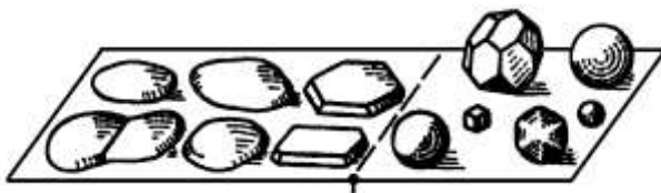
Рисунок 2 – Схема утворення плівок за різними механізмами конденсації
