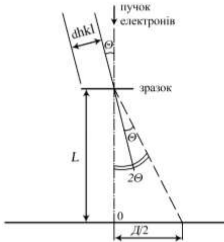
Рисунок 2 – Схема утворення електронोगрами
