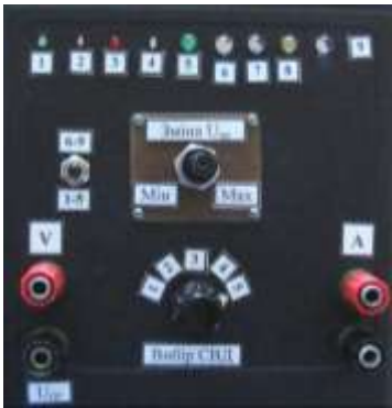
Рисунок 1 – Зовнішній вигляд лабораторного стенда для дослідження робочих характеристик СД
