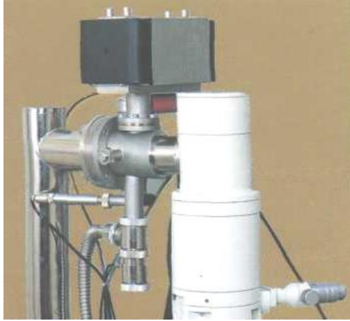
Рисунок 2.4 – Ілюстрація використання магнеторозрядного насоса для створення вакууму в об'ємі електронно-променевої гармати у мікроскопі JSM-840
