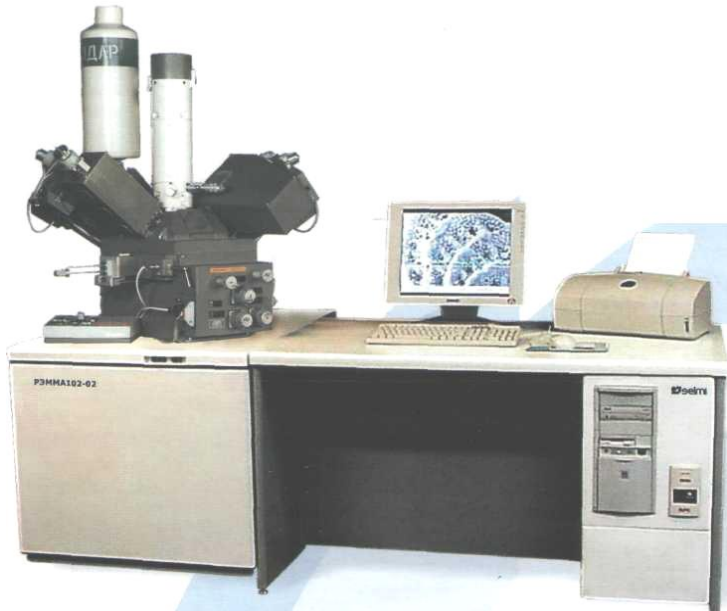
Рисунок 2.1 – Зовнішній вигляд мікроскопа PEMMA 102-01 виробництва ВАТ „Selmi” (м. Суми)
