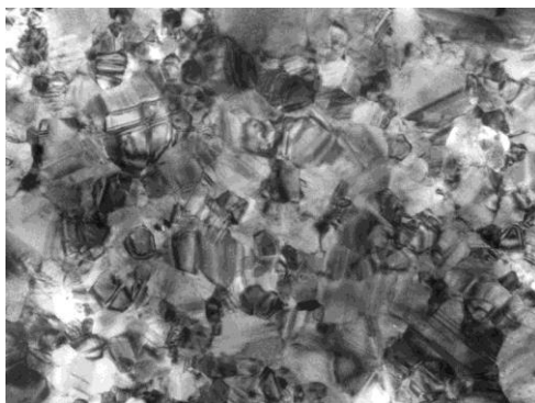
Рисунок 3.23 – Мікроснімок структури плівки Ni товщиною 100 нм, отриманий у світлопольному режимі. Збільшення M=5,3 \cdot 10^4
