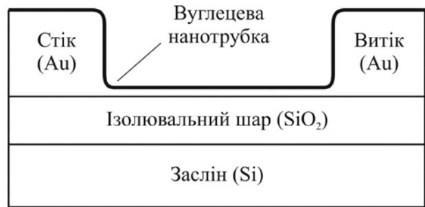
Рис. 3.21. Схема польового транзистора на основі вуглецевої нанотрубки
